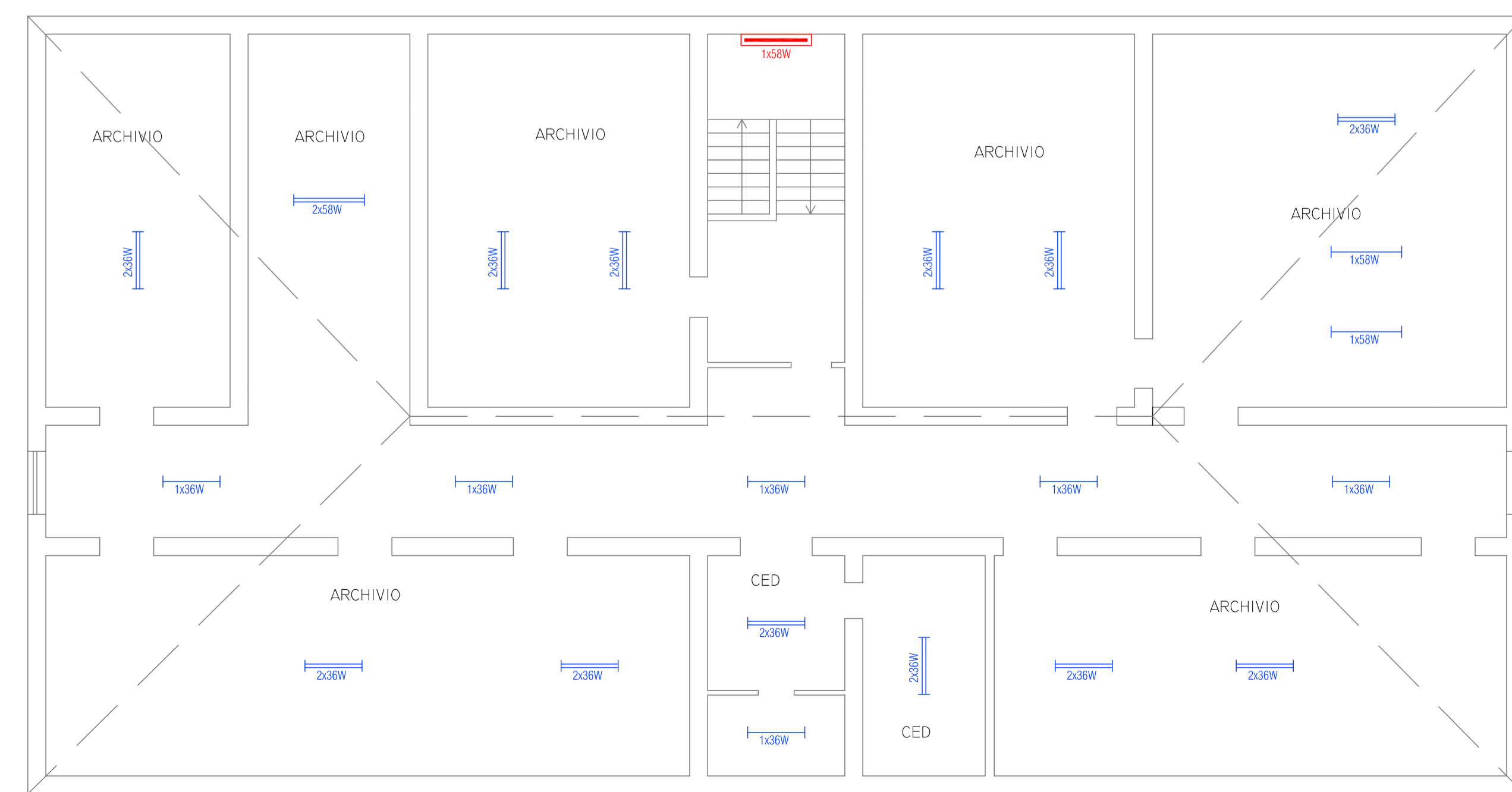
DISTRIBUZIONE ILLUMINAZIONE PIANO SOTTOTETTO (Scala 1:100) STATO DI FATTO
